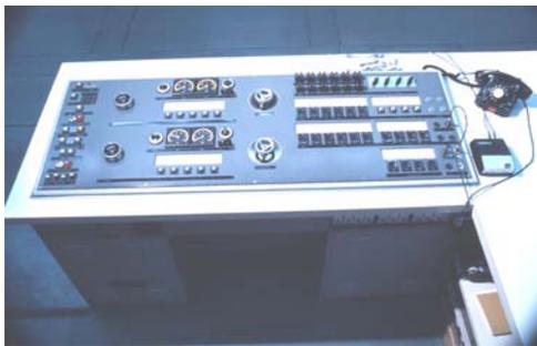
*Schaltpult zur Steuerung der Experimente. Auf den hinterleuchteten weissen Flächen können die entsprechenden Versuche angeschrieben werden.*
